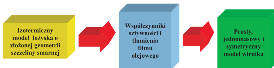
Rys. 3.65. Przyjęta kombinacja (schemat logiczny) modelu łożyska z prostym modelem wirnika
