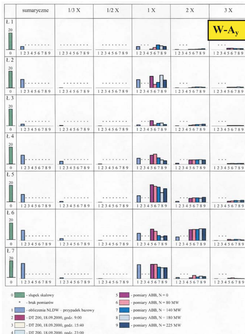
Rys. 3.31. Zestawienie pomiarów eksperymentalnych z wynikami obliczeń. Drgania względne panwi, składowa pionowa amplitudy A_y
