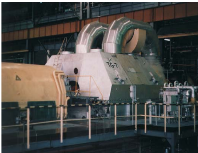
Rys. 3.17. Fotografia turbozespołu 13K215. Obiekty tej klasy przyjęte zostały do badań weryfikacyjnych opracowanych narzędzi badawczych
