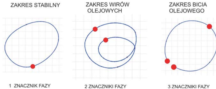
Rys. 5.21. Próba klasyfikacji niestabilności hydrodynamicznej w układzie i wprowadzenia wyróżników diagnostycznych
