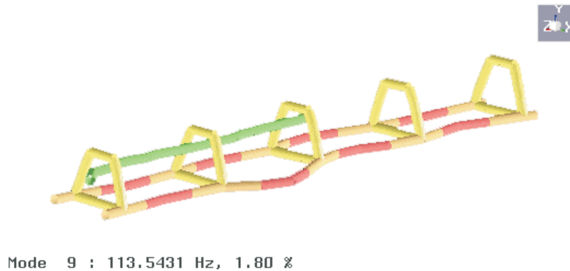
Rys. 8.27. Eksperymentalna analiza modalna. IX postać drgań własnych o częstotliwości 113,5 Hz [8.20]÷[8.22]
